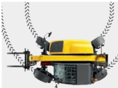
Allradlenkung: besonders wendig durch 2x40° Lenkwinkel.
