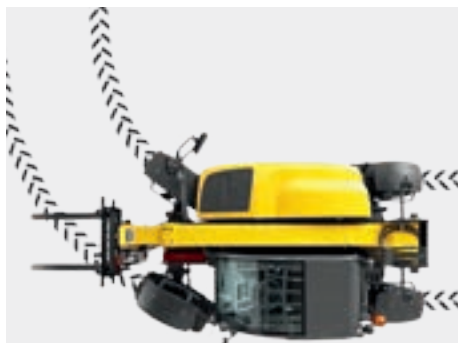
Vorderachslenkung: sicheres Fahrverhalten auch bei schneller Straßenfahrt.
